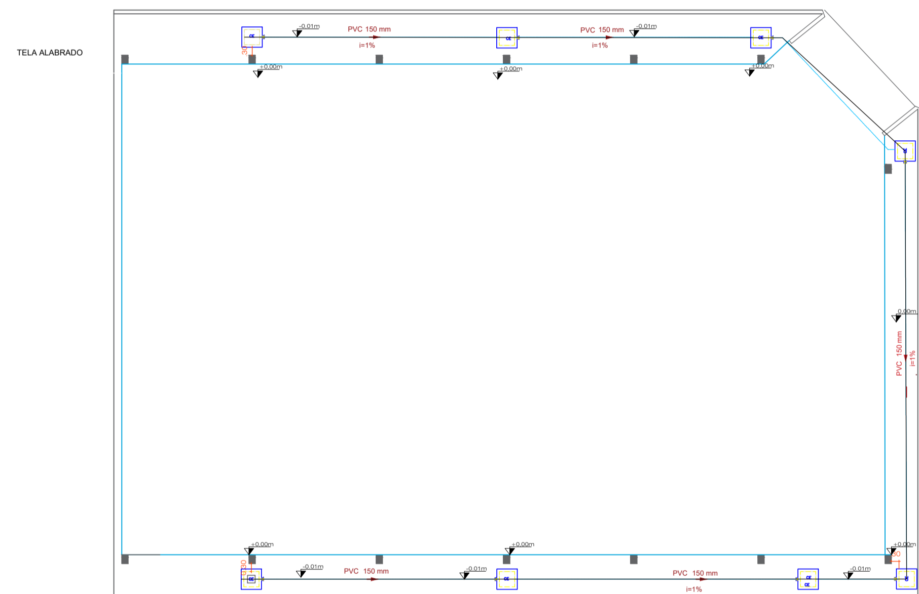
PLANTA BAIXA ESGOTO PLUVIAL Esc.
