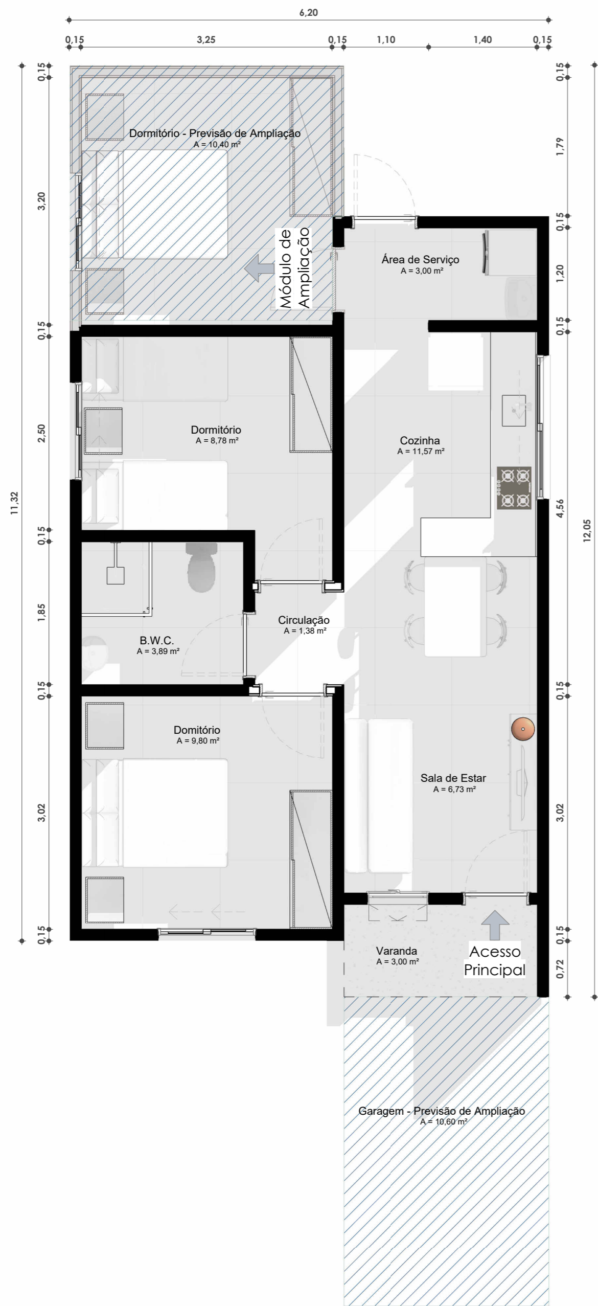
1 PLANTA DEMONSTRATIVA MÓDULO DE AMPLIAÇÃO - TIPO 01 ESCALA 1 : 50
