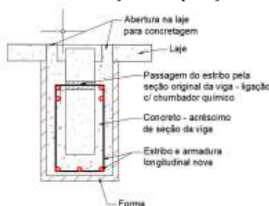
Imagem 04- Detalhe de execução, recuperação e concretagem V1
