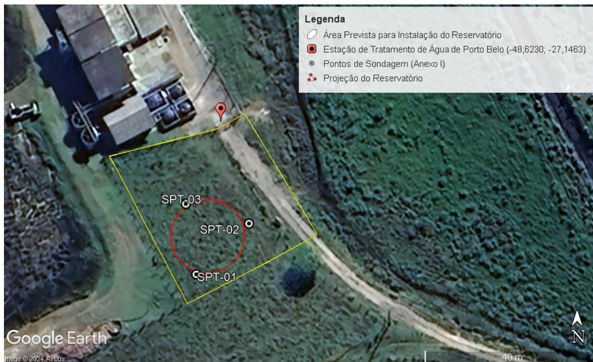
Figura 1 – Localização da área onde é prevista a instalação do reservatório, pontos de sondagem SPT realizada e projeção do reservatório.
