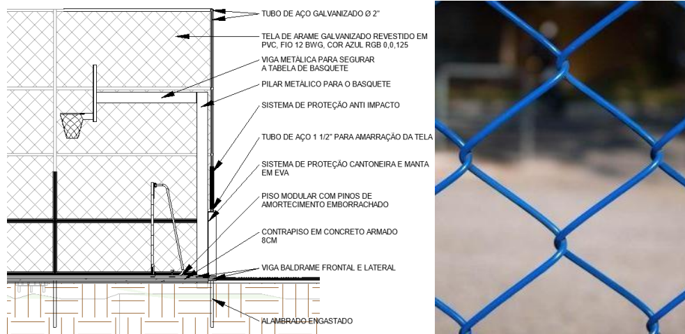
Figura 06 – Detalhe de alambrado (Fonte: Autor/2025)
