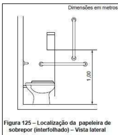
Figura 25 - Instalação de papeleira nos sanitários acessíveis. Fonte: NBR 9050/2020
