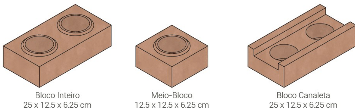
Figura 4: Dimensão dos blocos de solo-cimento
