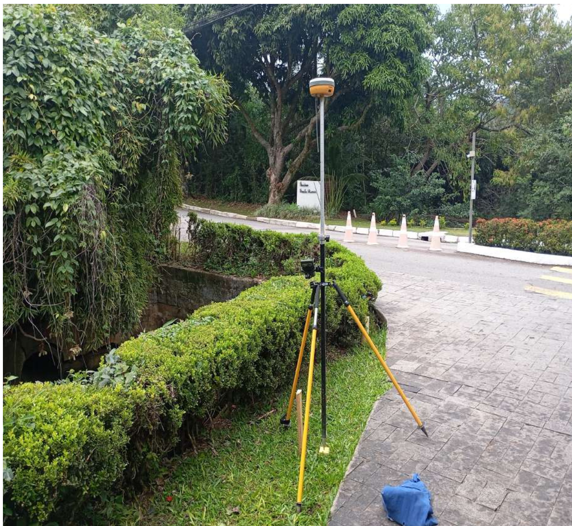
Figura 3.10 – Ponto Auxiliar – Poligonal Planialtimétrica
