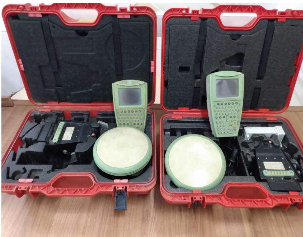
Figura 3.5 – Rastreador GNSS – Marca Leica – Modelo GG1200
