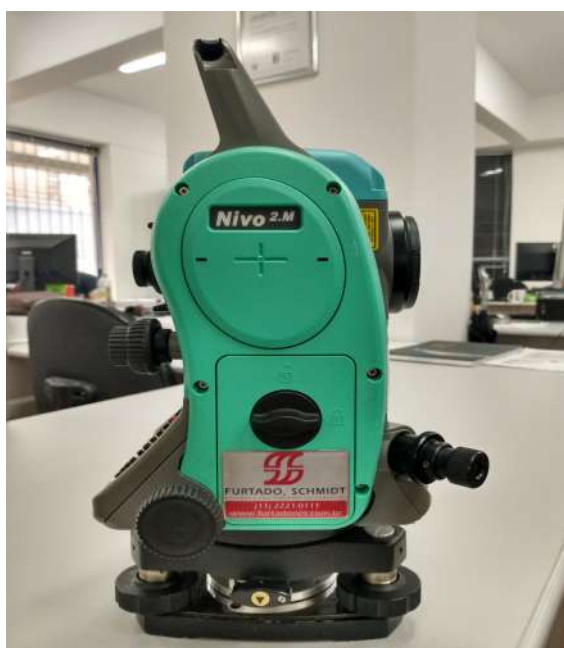
Figura 3.9 – Estação Total – Marca Nikon – Modelo NIVO-2M
