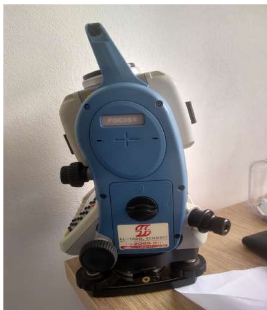
Figura 3.8 – Estação Total – Spectra Precision – Modelo Focus-6 2"
