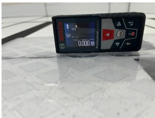
Figura 69 e Figura 70 e Figura 71 – Inclinações Rampa: entrada, trecho 1 e trecho 02, respectivamente.
