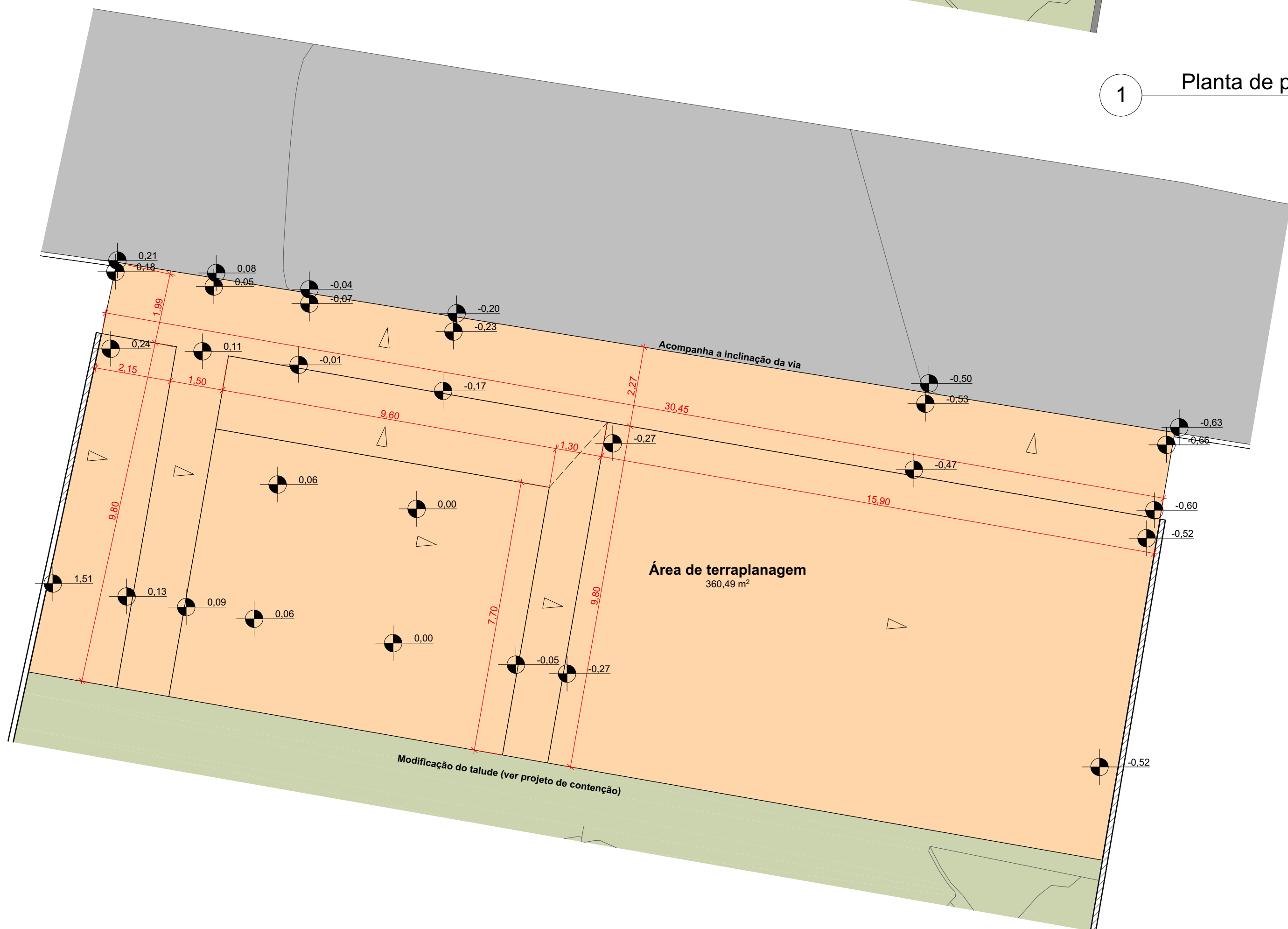
2 Planta de terraplanagem Escala: 1:100
