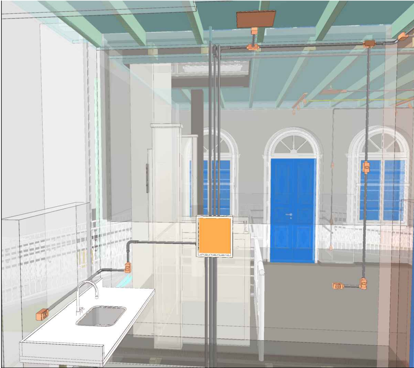
DETALHE DE INSTALAÇÃO METÁLICA DE SOBREPOR – PAVIMENTO TÉRREO SEM ESCALA (cotas em cm – bitolas em mm)
