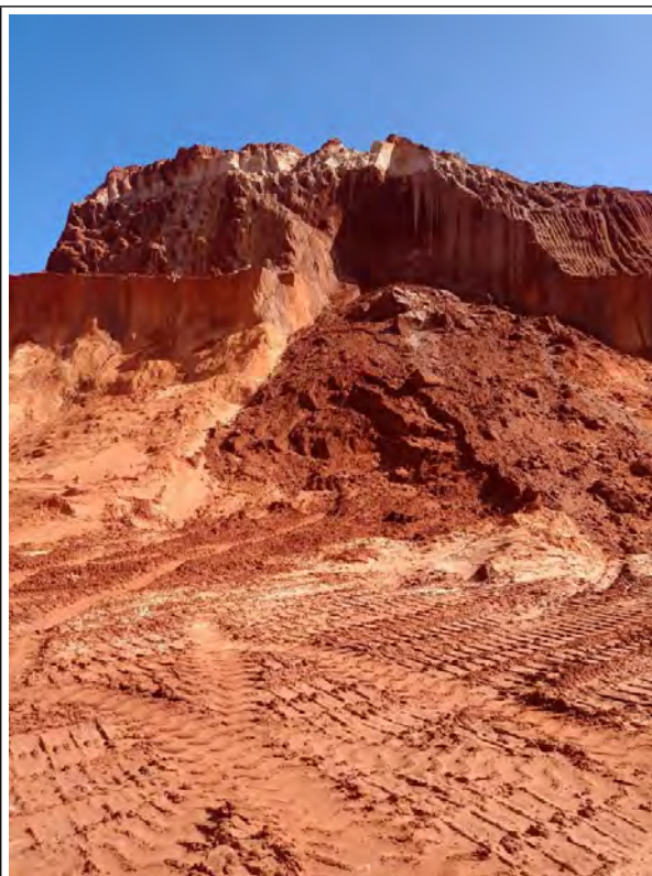
Figura 5.6 - Frente de exploração mostrando areia argilosa na porção superior e areia fina na porção inferior.
