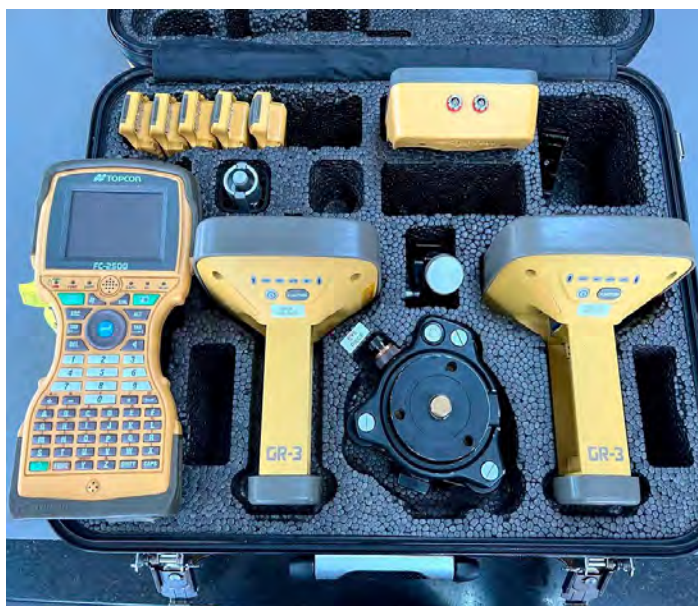
Figura 3.4 – Rastreador GNSS – Marca Topcon – Modelo GR-3
