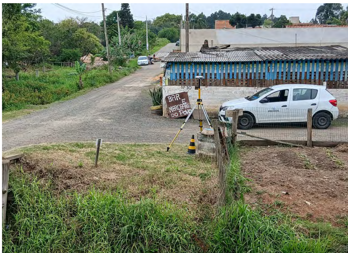
Figura 3.5 – Implantação e georreferenciamento de marco geodésico
