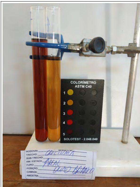
Figura 5.20 - determinação de matéria orgânica – Areal Ouro Branco - AM-01
