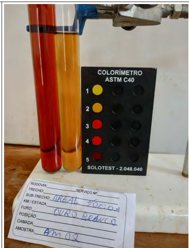
Figura 5.21 - determinação de matéria orgânica – Areal Ouro Branco - AM-02
