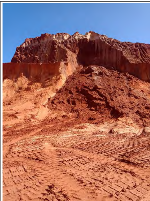
Figura 4.18 - Frente de exploração mostrando areia argilosa na porção superior e areia fina na porção inferior.
