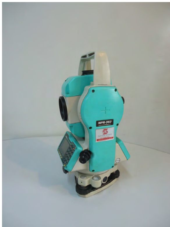
Figura 3.8 – Estação Total – Spectra Precision – Modelo NPR-362
