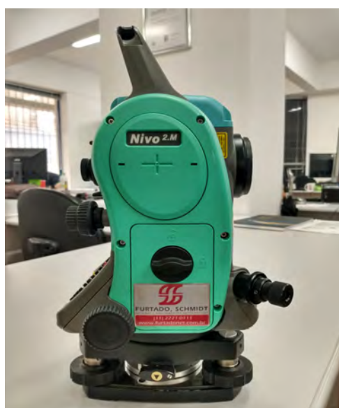
Figura 3.6 – Estação Total – Marca Nikon – Modelo NIVO-2M
