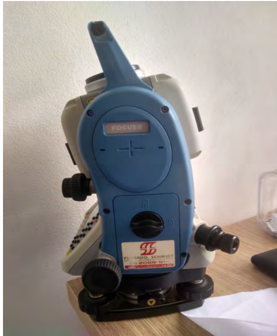
Figura 3.7 – Estação Total – Spectra Precision – Modelo Focus-6 2"
