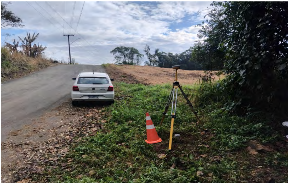
Figura 3.10 – Implantação e georreferenciamento de marco geodésico
