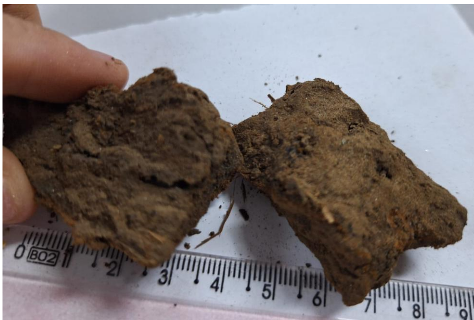
Figura 9: Amostra retirada do leito do rio para identificação táctil visual. Fonte: Sepagri, 2025.
