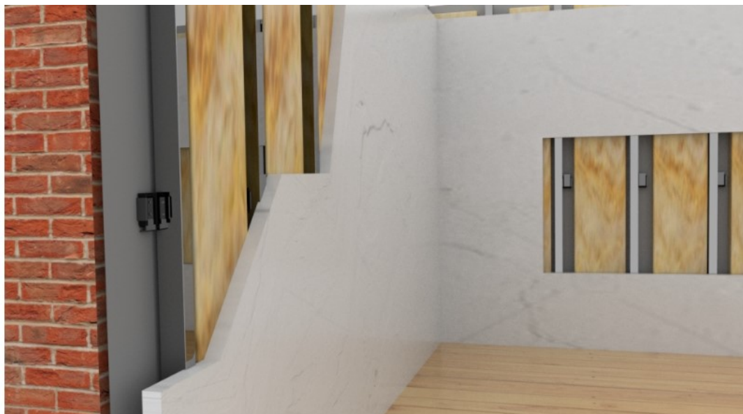
Imagem 2 – Parede Acústica Flutuante
