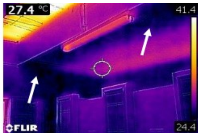
Figura 44 - Presença de umidade elementos estruturais do banheiro feminino
