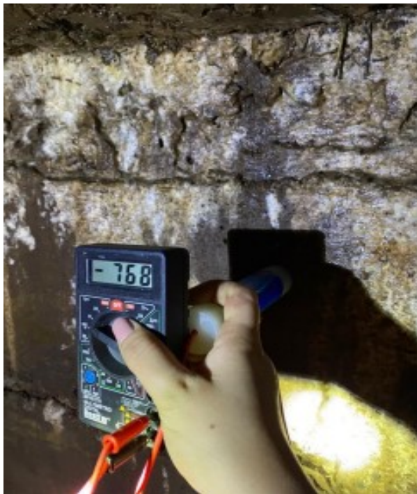
Figura 57 - Diferença de potencial menor -350 indicando alta probabilidade de corrosão da armadura
