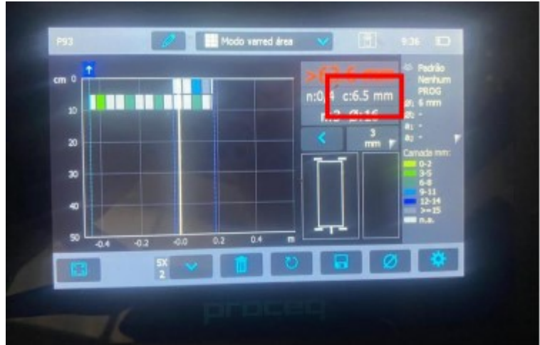
Figura 7 - Ensaio de Pacometria
