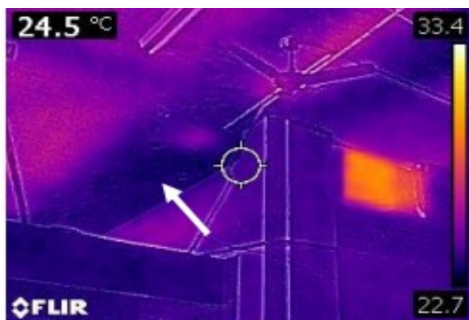
Figura 47 - Presença de umidade em toda extensão da calha de concreto
