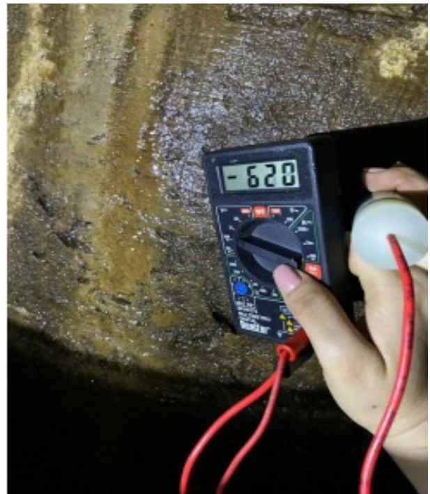
Figura 57 - Diferença de potencial menor -350 indicando alta probabilidade de corrosão da armadura
