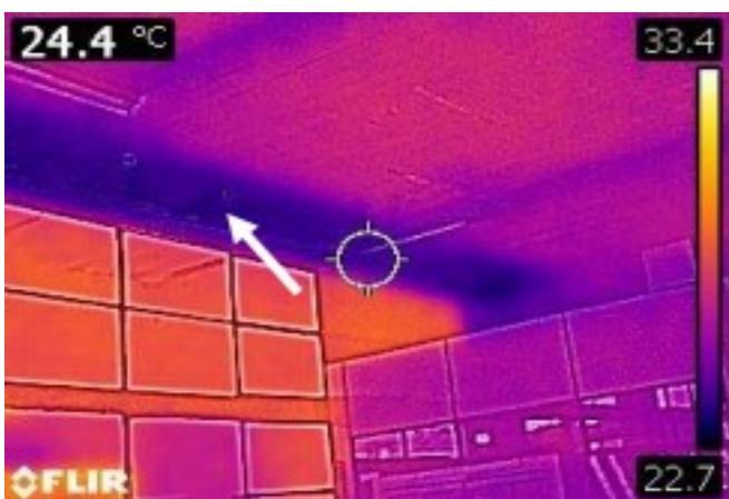
Figura 47 - Presença de umidade em toda extensão da calha de concreto
