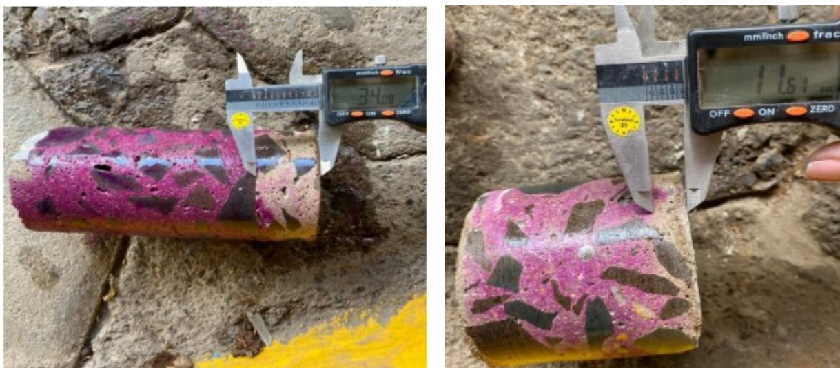
Figura 8 - Ensaio de profundidade de carbonatação
