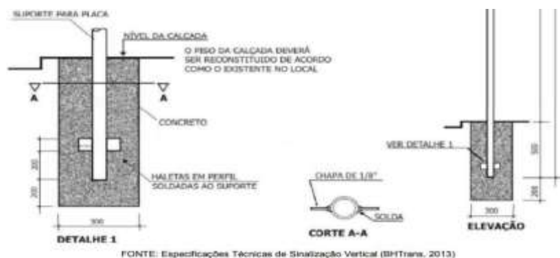
Figura 3 - Detalhe do Dispositivo Anti-Giro e da Fundação
