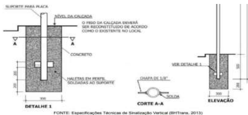
Figura 3 - Detalhe do Dispositivo Anti-Giro e da Fundação
