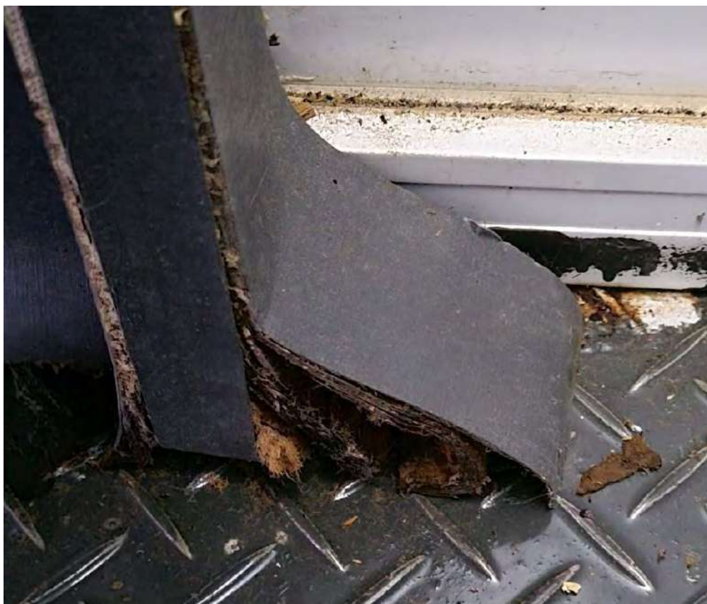
Figura 14 - Beliche apodrecido pela umidade
