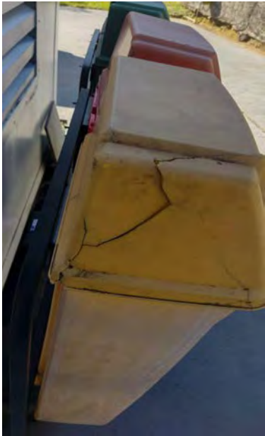
Figura 15. Lixeiras Externas Danificadas
