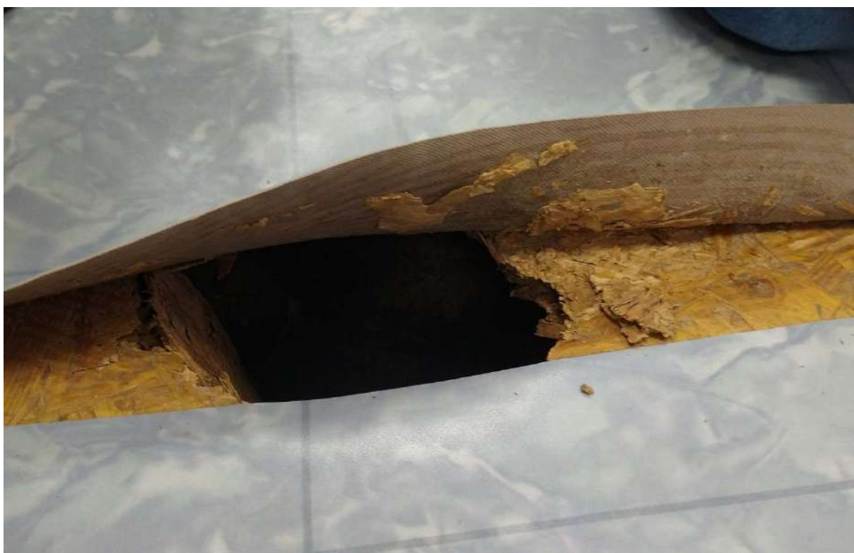
Figura 31. Desintegração da placa OSB.
