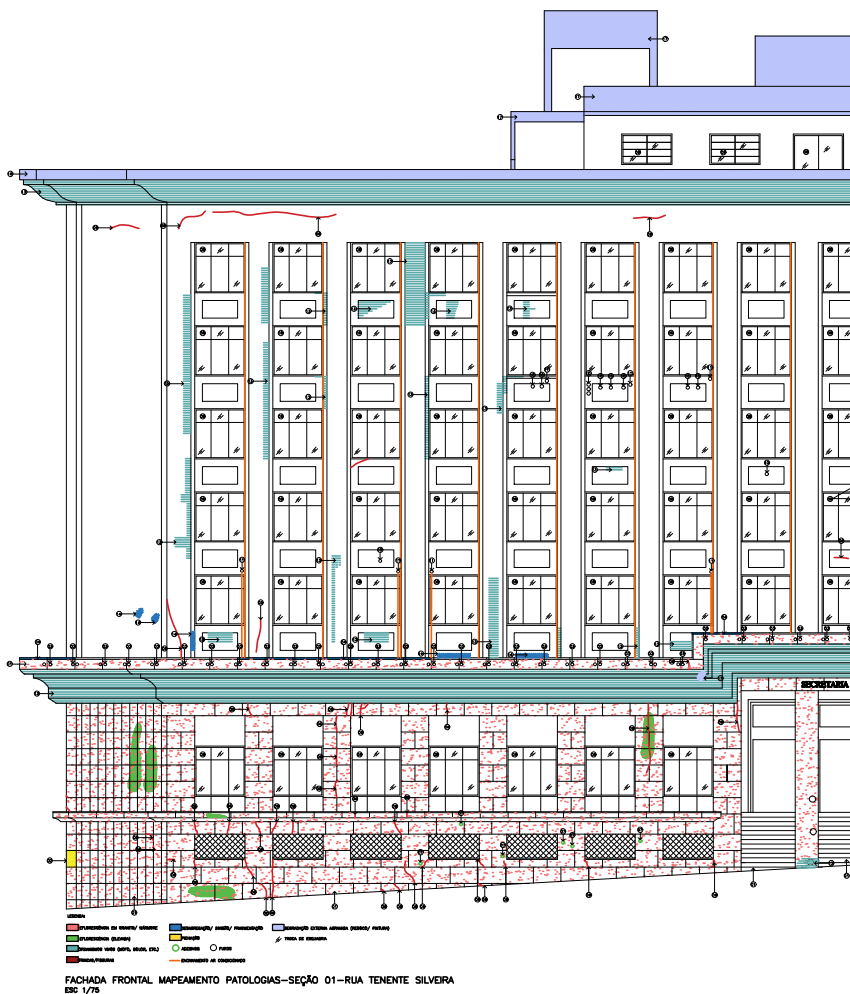
FACHADA FRONTAL MAPEAMENTO PATOLOGIAS-SEÇÃO 01-RUA TENENTE SILVEIRA ESC 1/75
