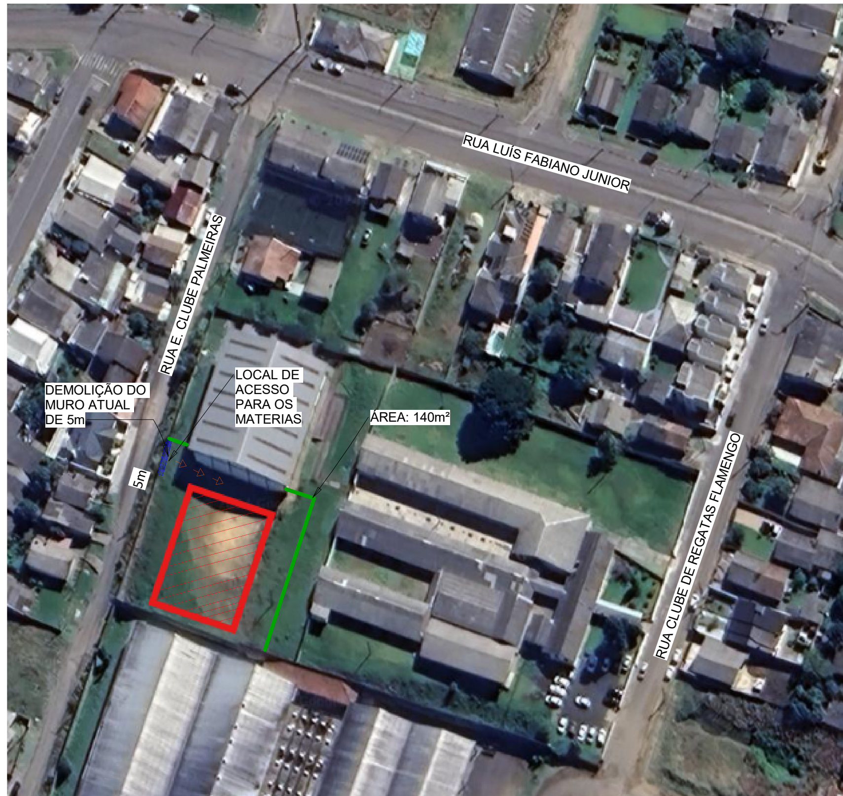
02 Planta de Demolição e Tapume Sem escala
