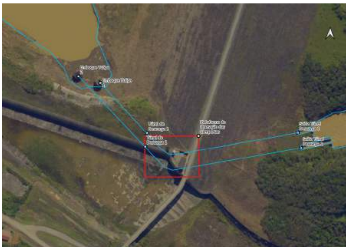
Figura 6.1-1 - Arranjo Geral Esquemático dos Túneis de Descarga
