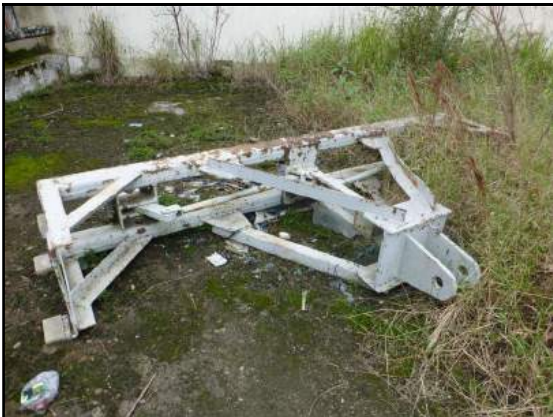
Fotos 61 – Viga Pescadora da Ponte Rolante de Manutenção das Comportas
