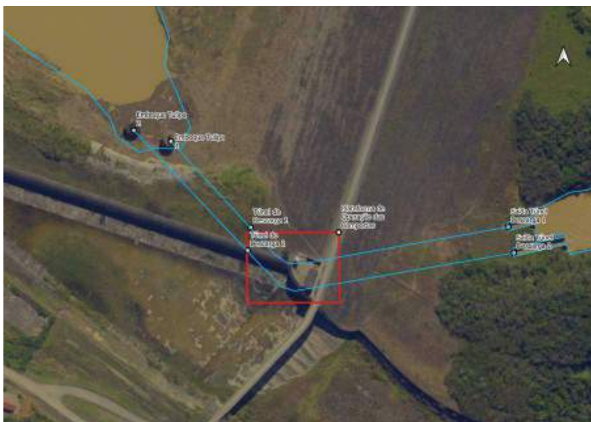
Figura 9.1-1 - Arranjo Geral Esquemático dos Túneis de Descarga
