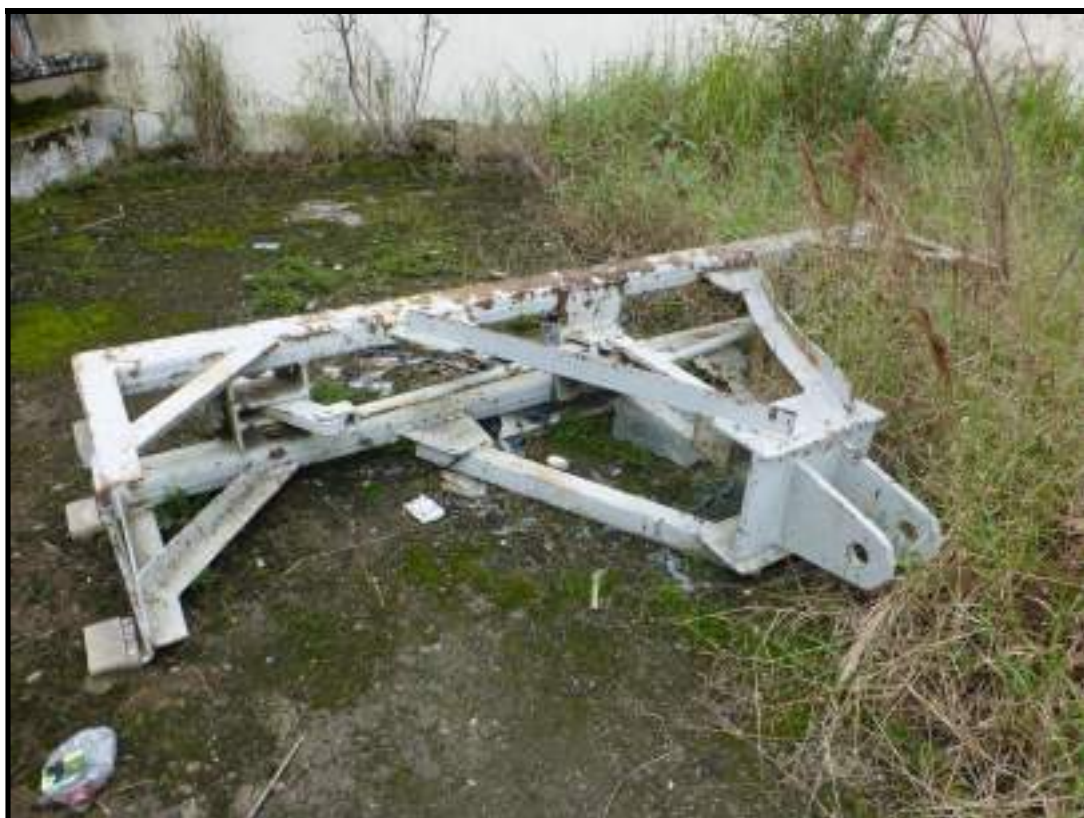
Fotos 5 – Viga Pescadora da Ponte Rolante de Manutenção das Comportas
