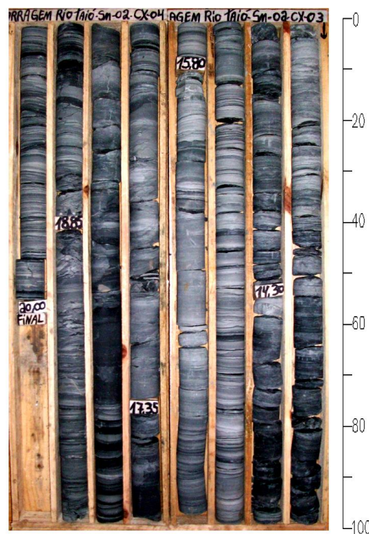
Figura 3.13 - Testemunhos da SM-02 cx 02 e 03. Idem descrição anterior. Notar estruturas sedimentares.
