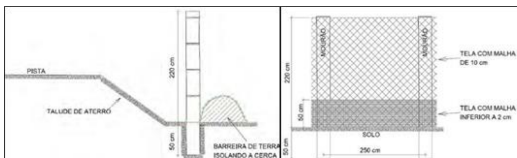
Figura 16. Detalhe da cerca direcionadora de fauna.
