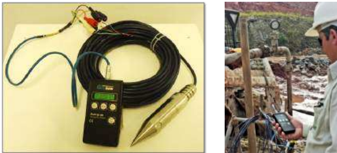
Figura 34 – Piezômetro de corda vibrante GEOKON Model 4500DP e leitora de dados.
