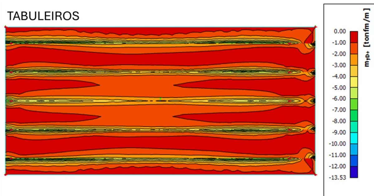
Figura 48: Momento fletor face positiva direção y M_{yd+} [tfm/m]
