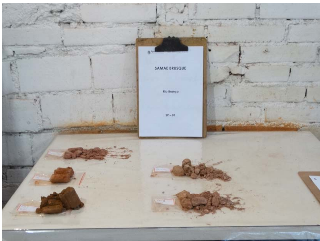
Foto 12 – Amostras do furo SP-01 dispostas para descrição. O topo se encontra no canto inferior esquerdo e a base, na porção central da mesa. Foto do autor.
