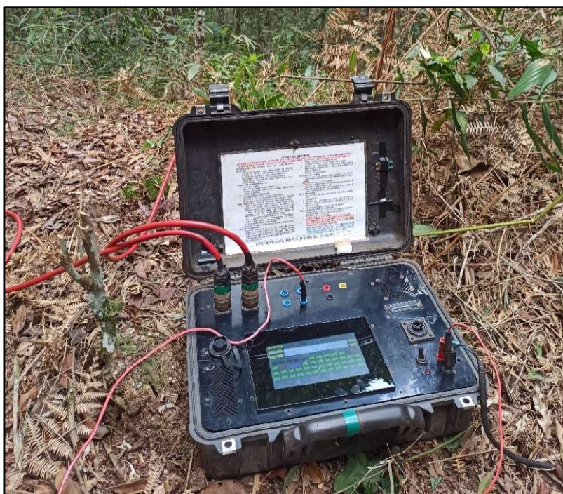
Figura 4 – Resistivímetro EEG AL-48b.
