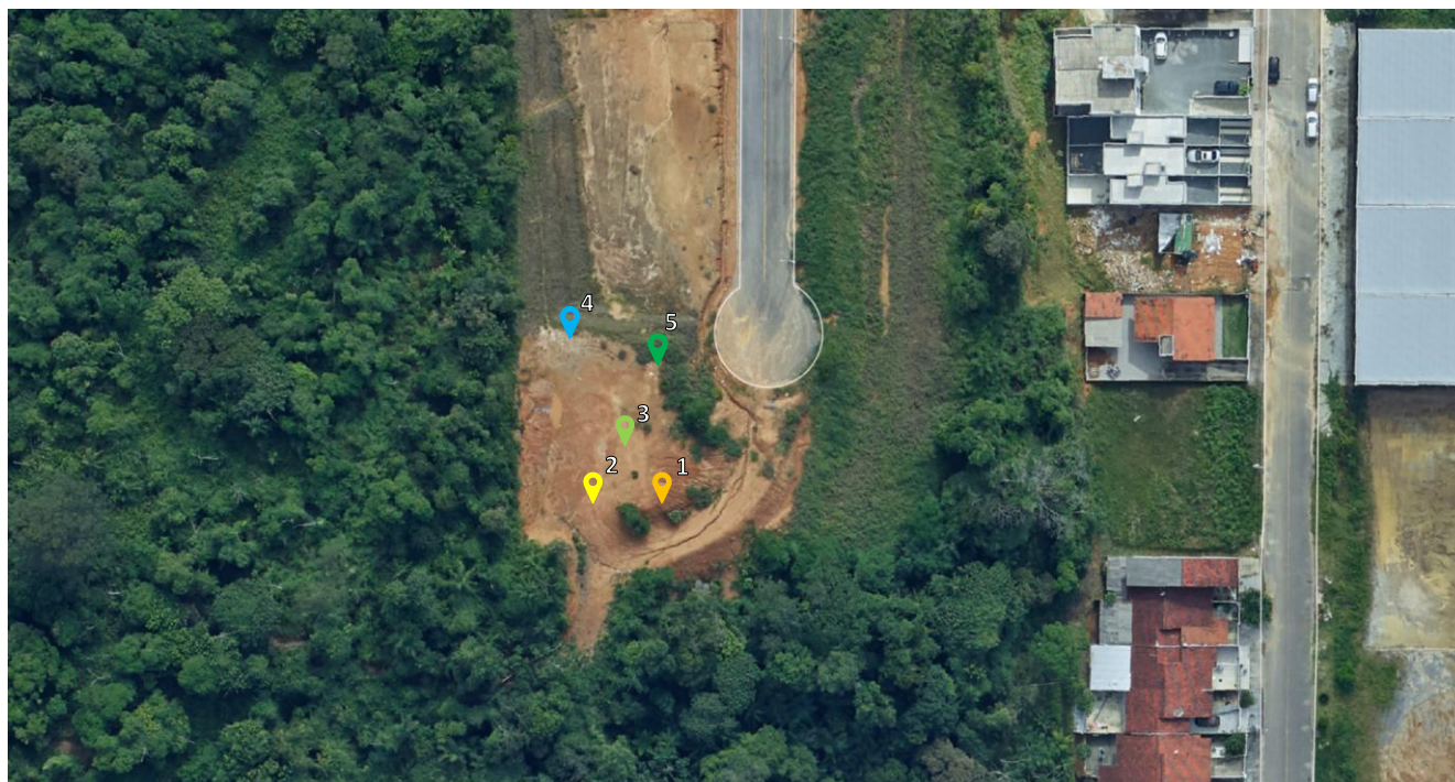
Figura 07. Pontos de sondagem executados no terreno.
