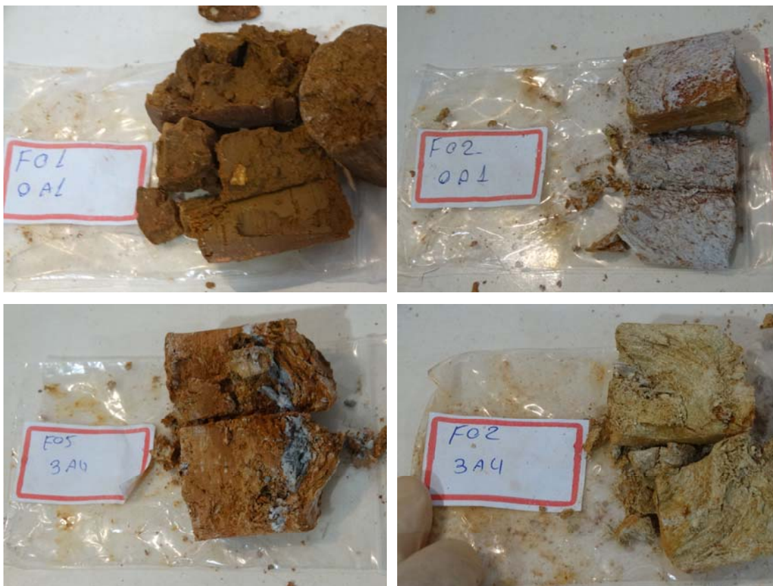
Fotos 13 a 16 – No alto, da esquerda para a direita = a) solo coluvionar, argiloso, com fragmentos de rochas dispersos na matriz; b) solo residual de rochas do Complexo Metamórfico de Brusque, a superfície esbranquiçada representam minerais intemperizados que recobrem um espelho de microfratura; c) solo residual, com fragmentos de xisto (cinza escuro) em meio à uma massa de minerais intemperizados (castanho) e d) solo residual aonde se pode observar indícios de uma dobra na rocha matriz. Fotos do autor.
