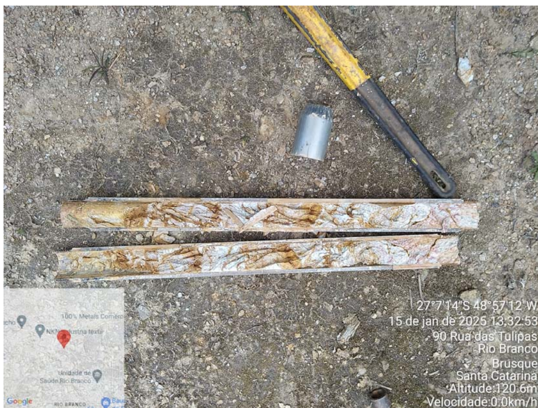
Foto 11 – Amostrador bi-partido aberto expondo a ótima recuperação de amostras. Foto Sergio.
