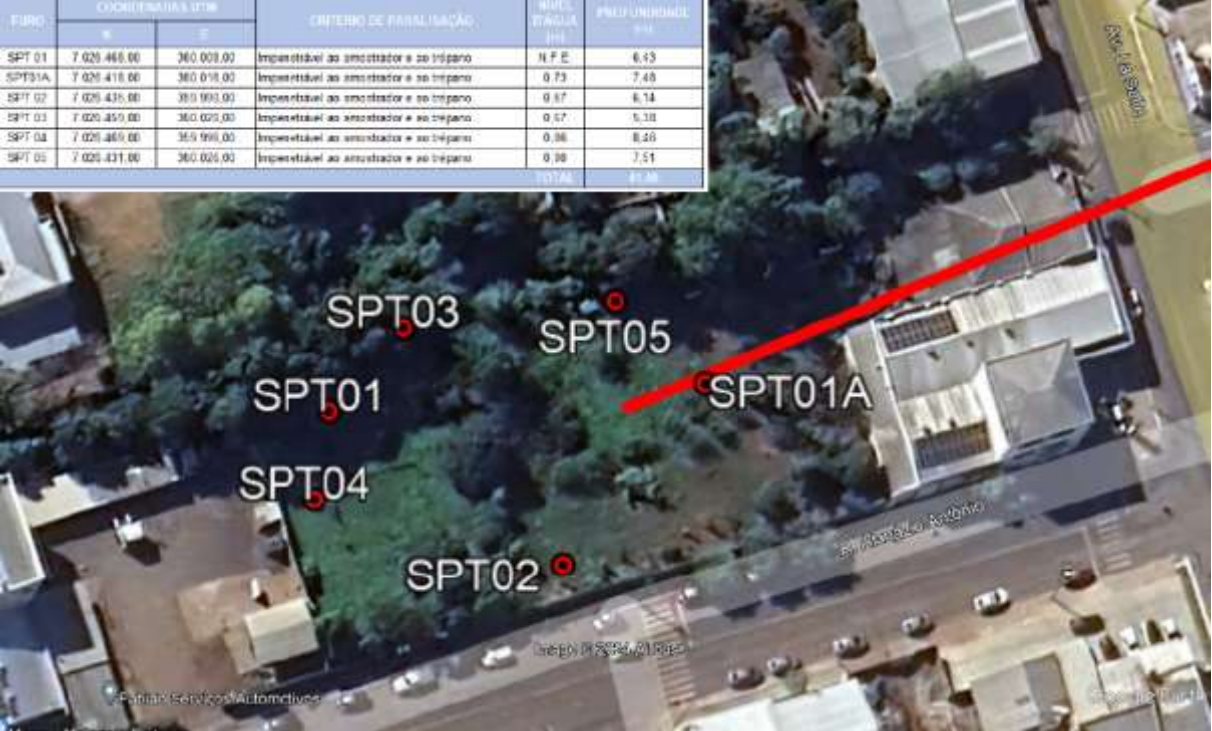
Figura 3: Planta de locação das sondagens a percussão.
