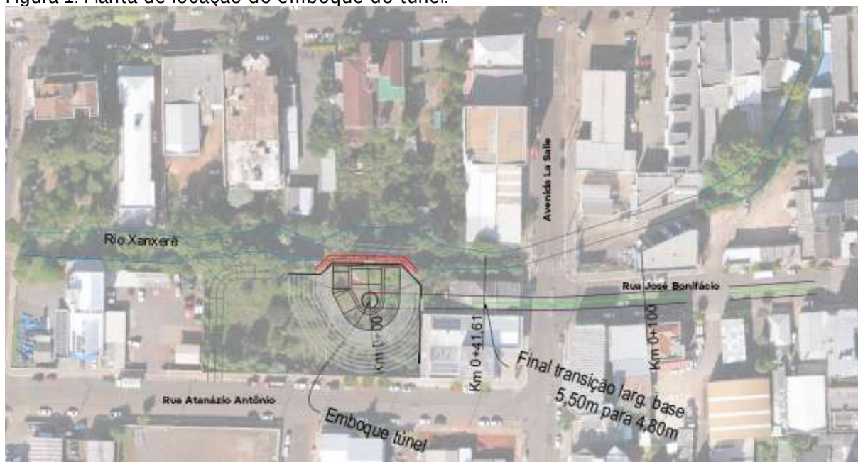
Figura 1: Planta de locação do emboque do túnel.
