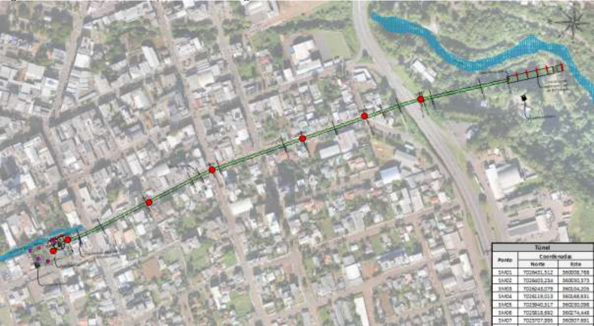
Figura 4: Planta com locação das sondagens mistas.
