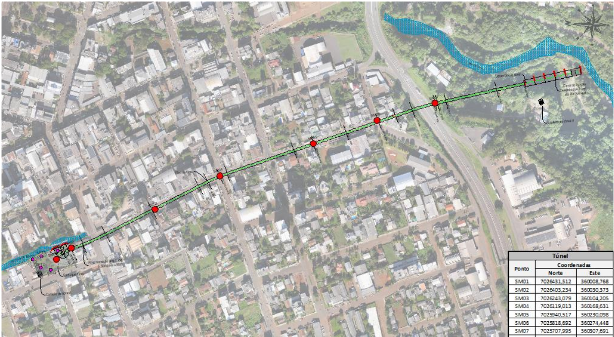
Figura 4: Planta com locação das sondagens mistas.
