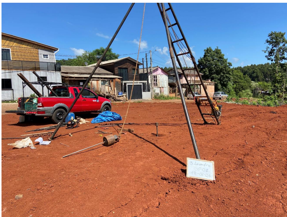
Figura 5. Execução da SP-01.
