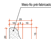
DETALHE 03 - MEIO-FIO PRÉ-MOLDADO Escala 1:20
