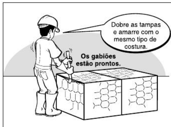
Figura 14 – Detalhe da etapa de fechamento do gabião tipo caixa
