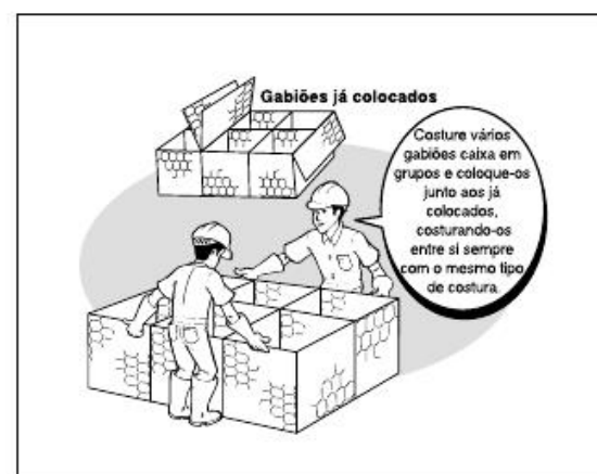
Figura 9 – Posicionamento dos gabiões
