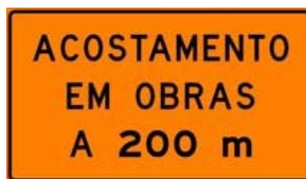
Figura 4-6 - Sinal de acostamento em obras a ..... metros
