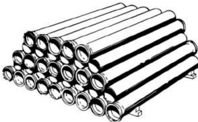
Imagem 9 - Empilhamento de tubos leitos superpostos com bolsas em lados alternados;
