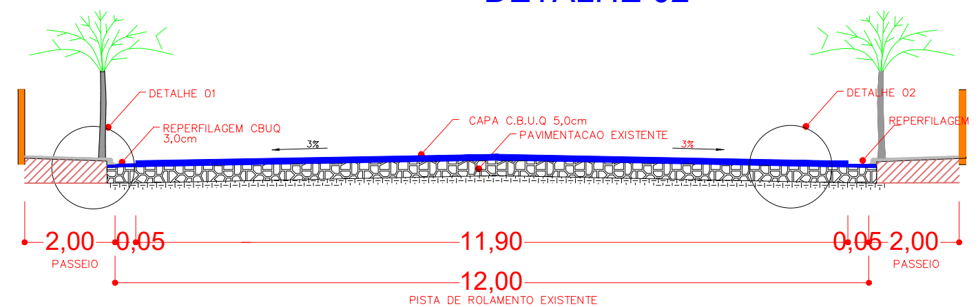
SECAO TRANSVERSAL DO PAVIMENTO SEM ESC. RUA IVENS DE ARAUJO ( TRECHO 01 )
