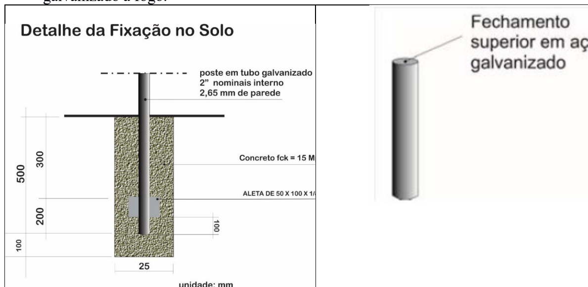
Figura 1 – Detalhes das aletas anti-giro para suportes galvanizados.
