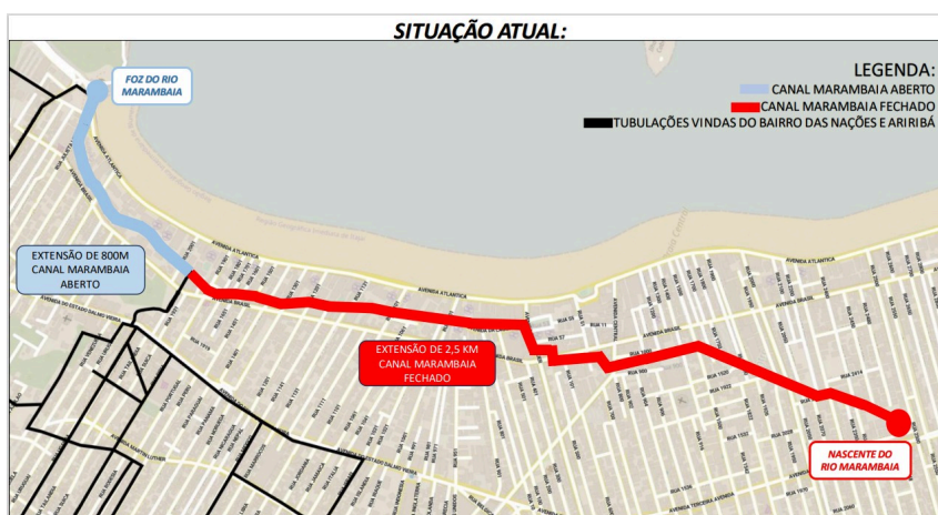
Figura 4 - Situação atual do Canal Marambaia.
