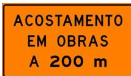
Figura 4-4 - Sinal de acostamento em obras a ..... metros
