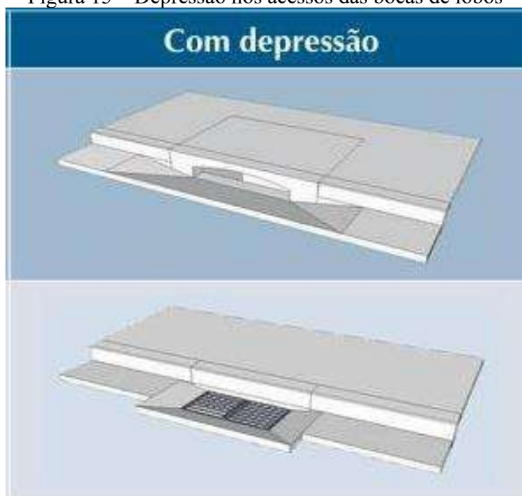
Figura 15 – Depressão nos acessos das bocas de lobos
