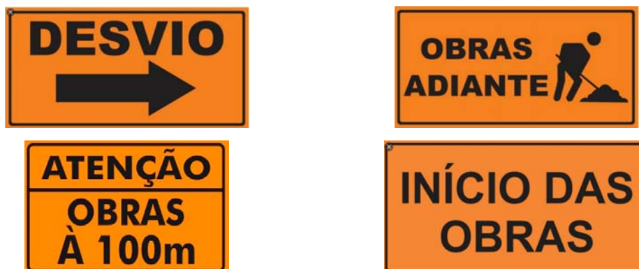
Figura 4 – Placa em chapa de aço galvanizado com resistência a intempéries. Dimensões: 1,00 x 0,50 m
