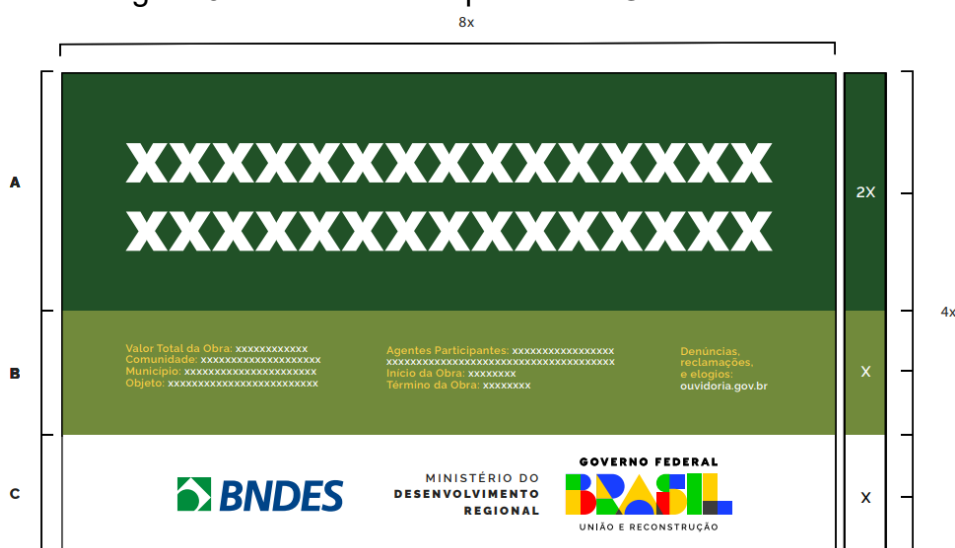
Figura 3 – Placa de obra padrão do Governo Federal
