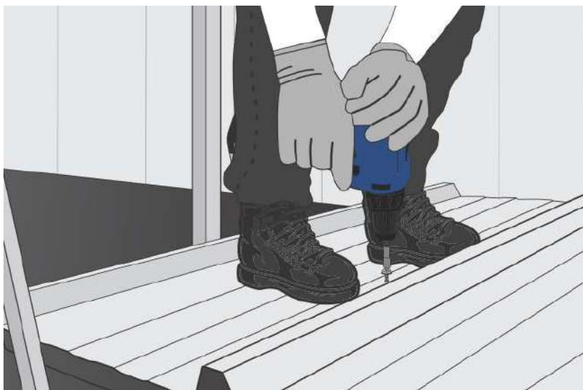
Figura 6: Início execução telha termoacústica.
