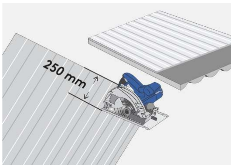
Figura 9: Recortes telhas termoacústicas.
