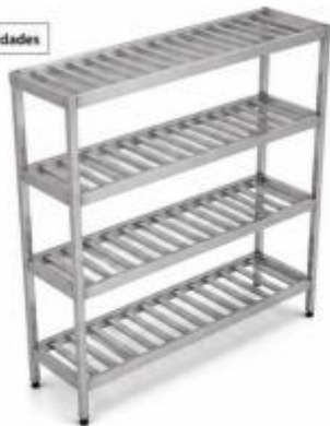
Fechamento lateral das prateleiras | Prateleira gradeada com reforços (Chapa #19) | Estrutura em aço inox 304 | Pé tubo Ø38,1mm com niveladores | Topo (teto) escovado
