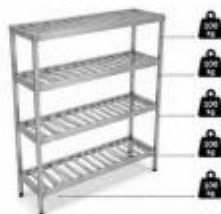
Fechamento lateral das prateleiras | Prateleira gradeada com reforços (Chapa #19) | Estrutura em aço inox 304 | Pé tubo Ø38,1mm com niveladores | Topo (teto) escovado
