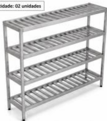
Fechamento lateral das prateleiras | Prateleira gradeada com reforços (Chapa #19) | Estrutura em aço inox 304 | Pé tubo Ø38,1mm com niveladores | Topo (teto) escovado
