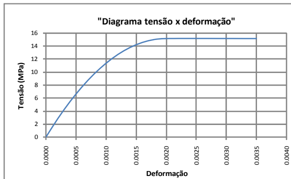
Diagrama conforme item 8.2.10.1 da NBR-6118
