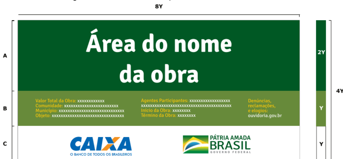
Figura 5 – Placa de obra padrão do Governo Federal
