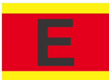
Sinalização de extintor em coluna
