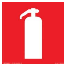
Sinalização do extintor conforme NR 16820
