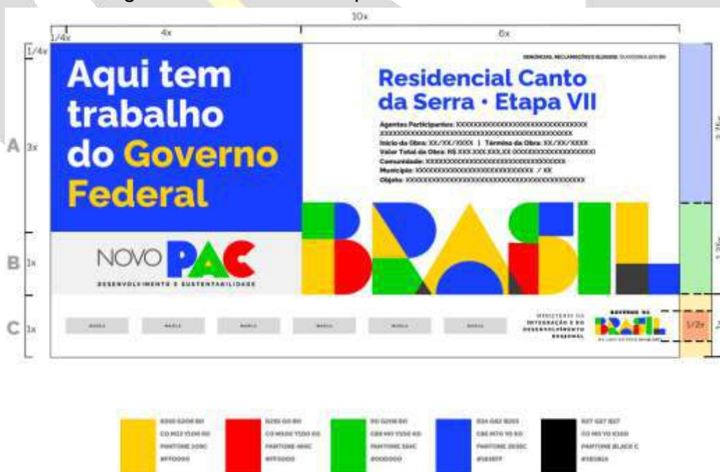
Figura 3 – Placa de obra padrão do Governo Federal
